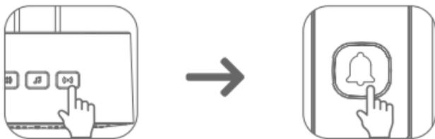
Assicurati che il videocitofono sia completamente carico e che l'altoparlante sia collegato alla presa, e posizionali il più vicino possibile durante l'associazione. Premi il tasto di associazione dell'altoparlante fino al segnale acustico, poi premi velocemente il tasto campanello del videocitofono. A questo punto, l'associazione è completata. Premi il tasto del videocitofono e si sentirà il suono dall'altoparlante.
